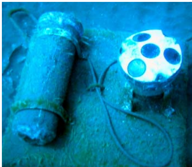
Figura 13 .- Perfilador Doppler Nortek AWAC fondeado frente a la Playa de Tazacorte
