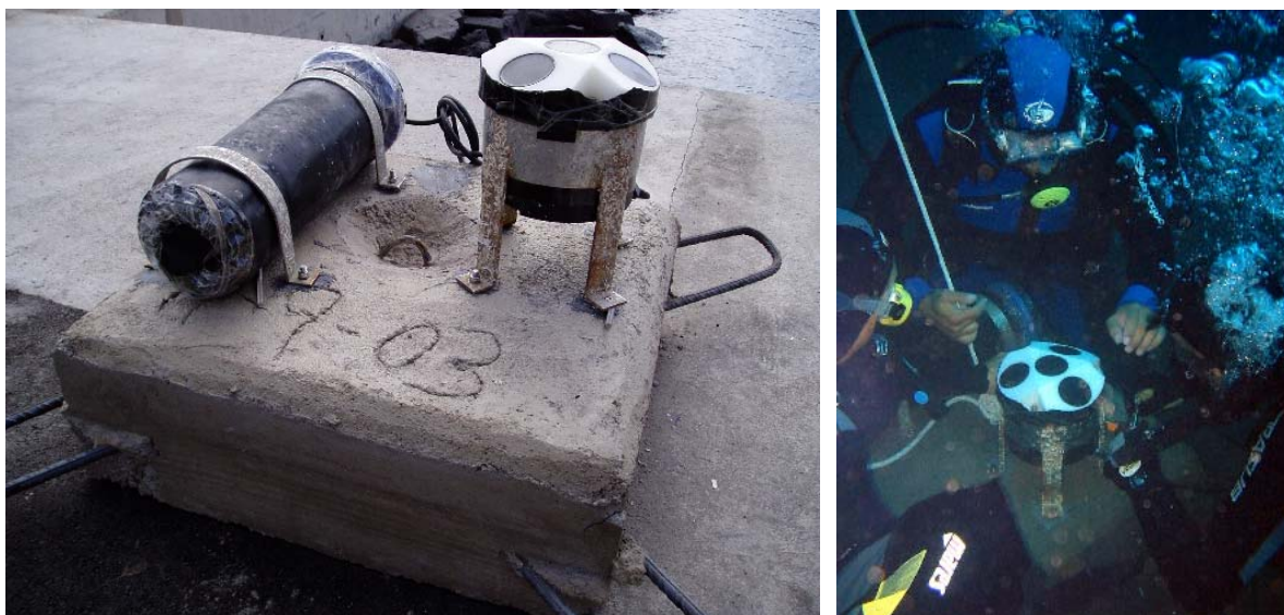
Figura 11 .- Fijación de la batería y los transductores del perfilador Doppler al muerto de hormigón
