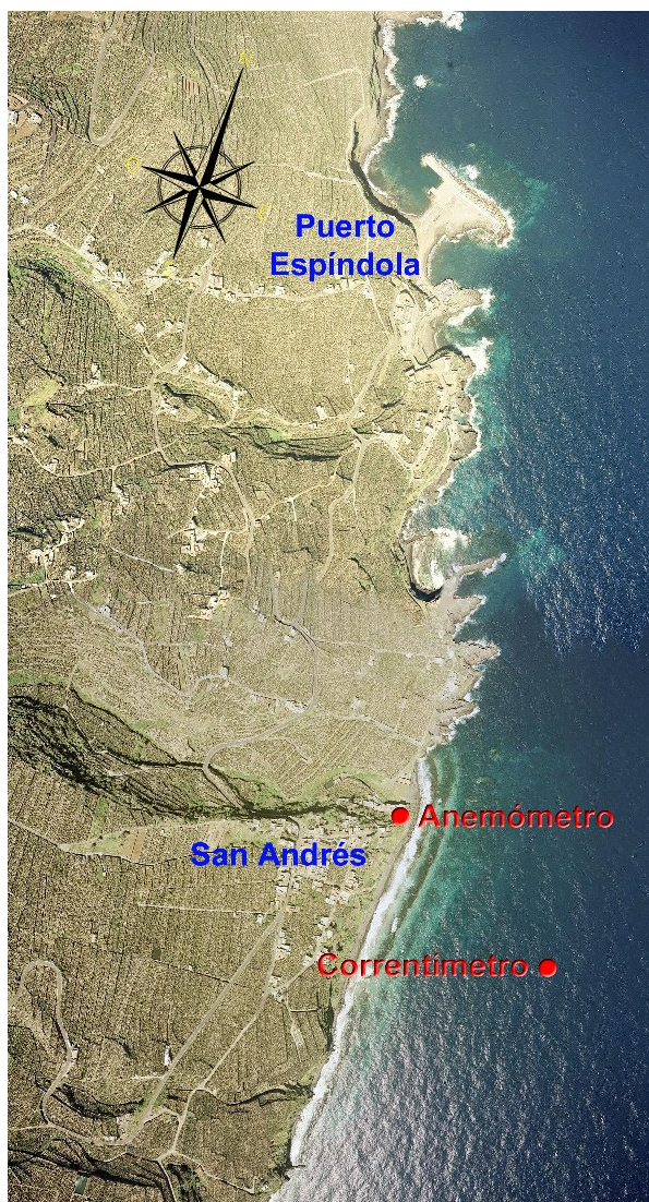
Figura 18 .- Localización del correntímetro y el anemómetro en Puerto Espíndola (septiembre-octubre 2004)
