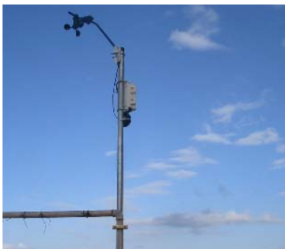
Figura 17 .- Aneómetro Davis instalado en San Andrés
