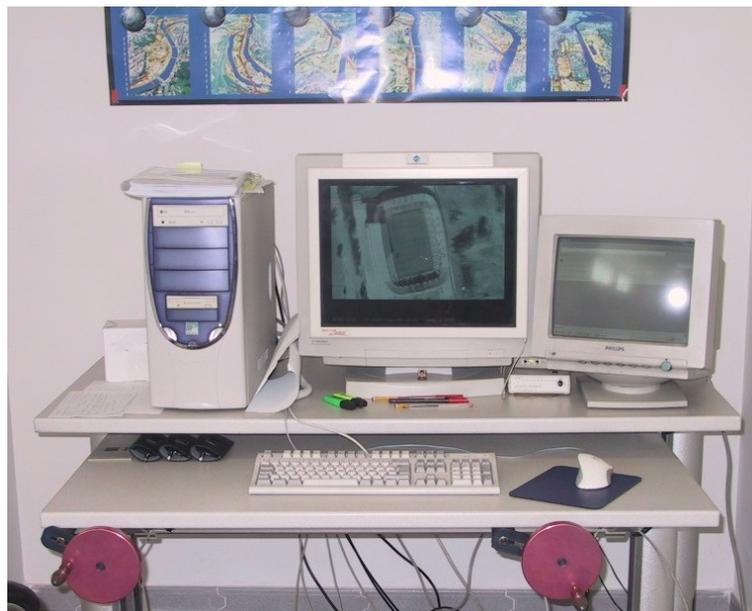
figura 6 Restituidor digital Analyzer RD-2001
