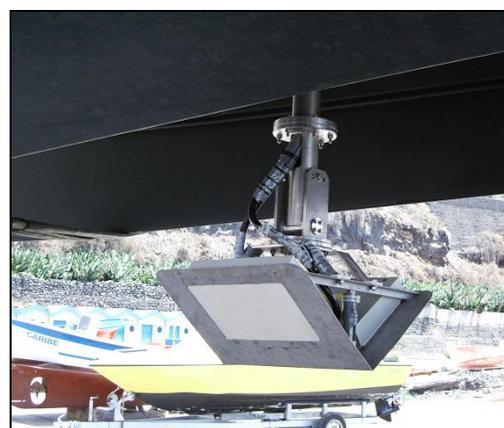
Figura 9 Unidad central de la Seabeam1000 (a la izquierda) y situación de los transductores en la embarcación utilizada (a la derecha).
