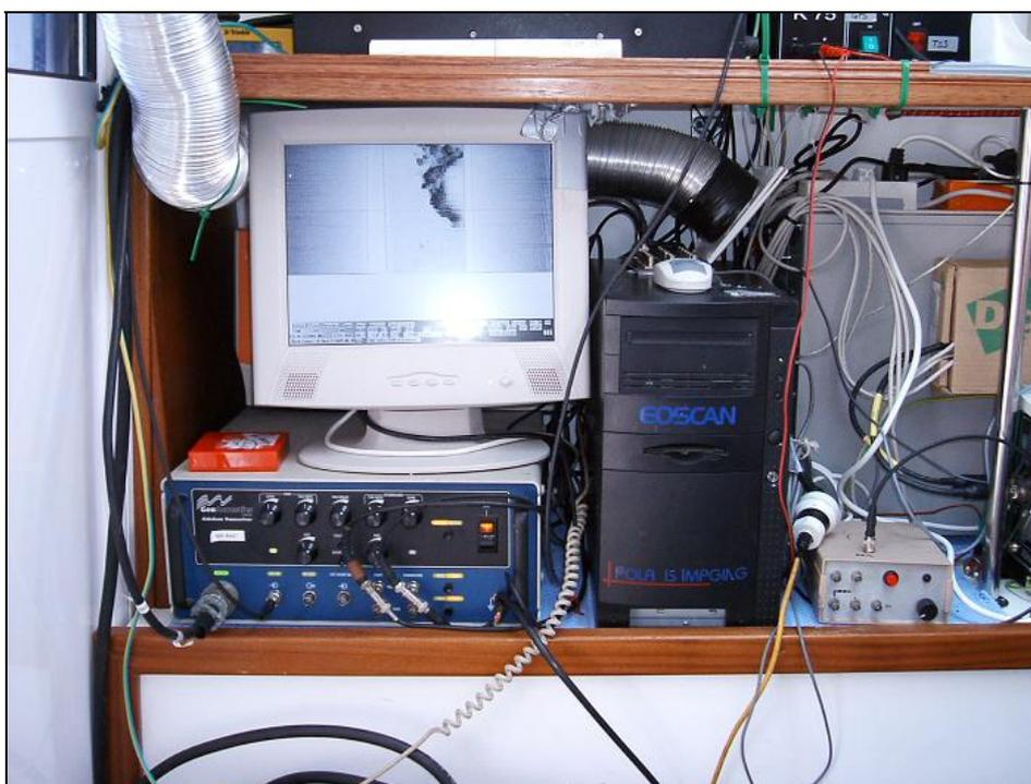
Figura 26 . Sistema de adquisición de datos de Sónar de Barrido Lateral.
