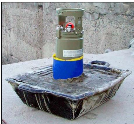
Figura 20 . Mareógrafo Aanderaa WLR-7 antes de ser fondeado en su posición definitiva. Obsérvese la base de cemento para su fijación en el fondo.
