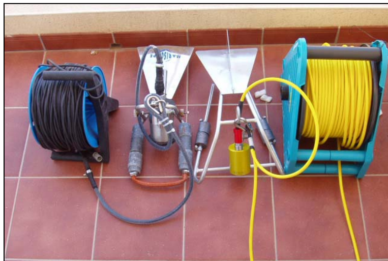
Figura 48 .- Equipos de video remolcado MARISCOPE, modelo MICRO utilizados
