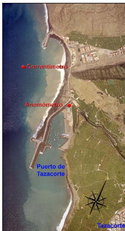
Figura 25 .- Localización del correntímetro y el anemómetro en Tazacorte (febrero-marzo 2004)
