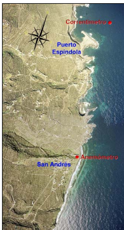
Figura 26 .- Localización del correntímetro y el anemómetro en Tazacorte (febrero-marzo 2004)
