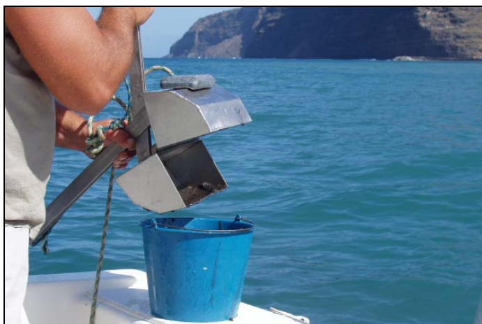
Figura 46 .- Trabajos de muestreo con draga Van Veen
