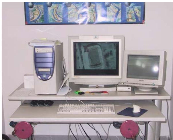
Foto nº 2 Restituidor digital Analyzer RD-2001
