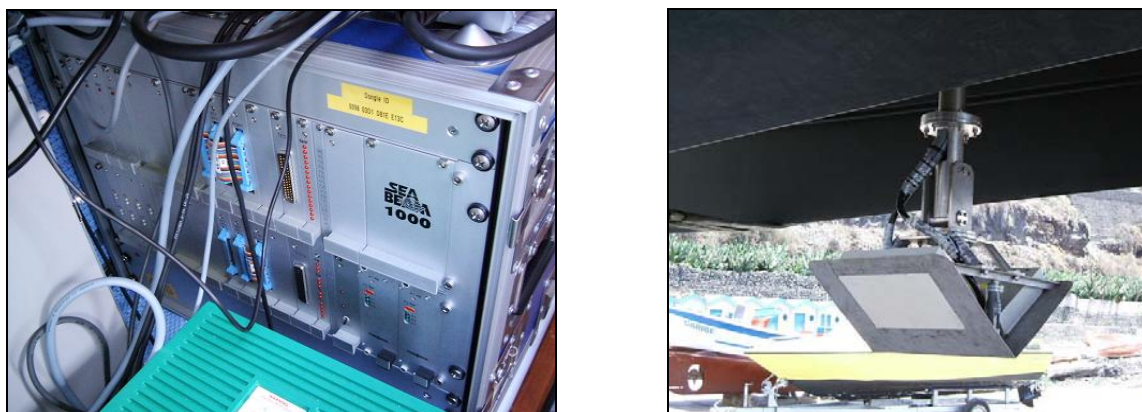
Figura 13 .- Unidad central de la Seabeam1000 (a la izquierda) y situación de los transductores en la embarcación utilizada (a la derecha).
