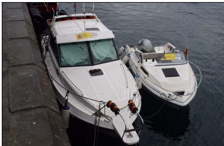
Figura 45 .- Embarcación de fibra de 6 metros de eslora usada para el mapeado en continuo
