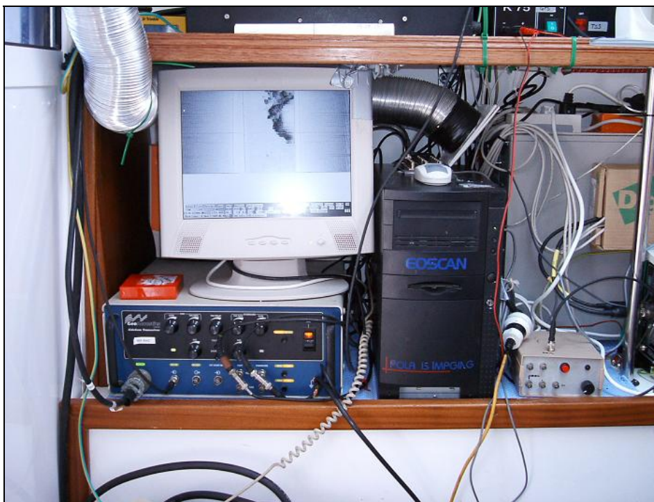
Figura 22 .- Sistema de adquisición de datos de Sónar de Barrido Lateral.
