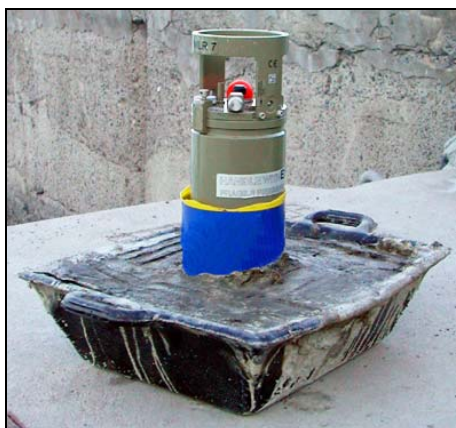
Figura 17. - Mareógrafo Aanderaa WLR-7 antes de ser fondeado en su posición definitiva. Obsérvese la base de cemento para su fijación en el fondo. Equipos de gabinete
