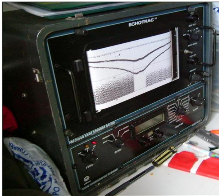
Figura 14 . Sonda acústica ECHOTRAC DF-3200
