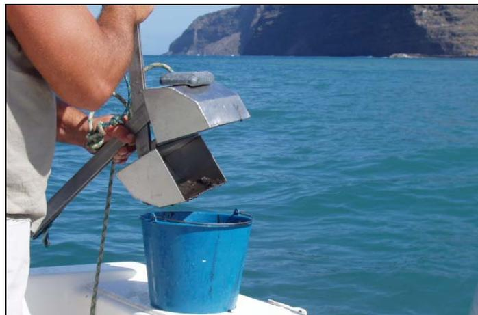
Figura 46 .- Trabajos de muestreo con draga Van Veen
