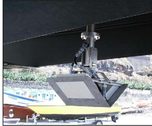
Figura 13 .- Unidad central de la Seabeam1000 (a la izquierda) y situación de los transductores en la embarcación utilizada (a la derecha).
