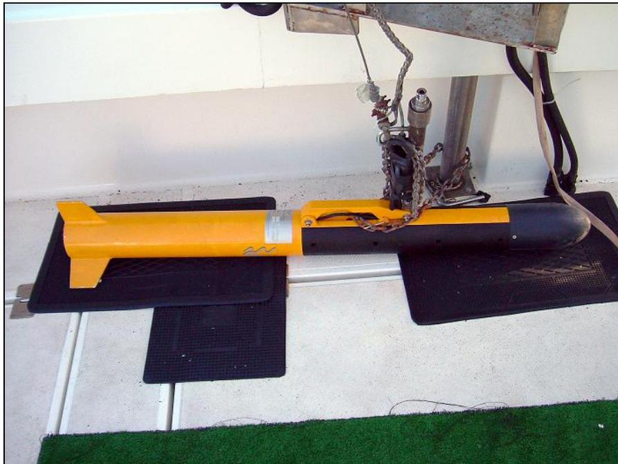
Figura 23 .- Unidad trasmisora-receptora GeoAcoustic.
