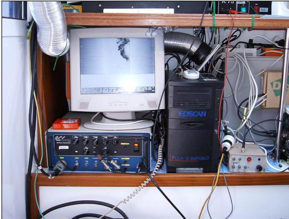
Figura 22 .- Sistema de adquisición de datos de Sónar de Barrido Lateral.
