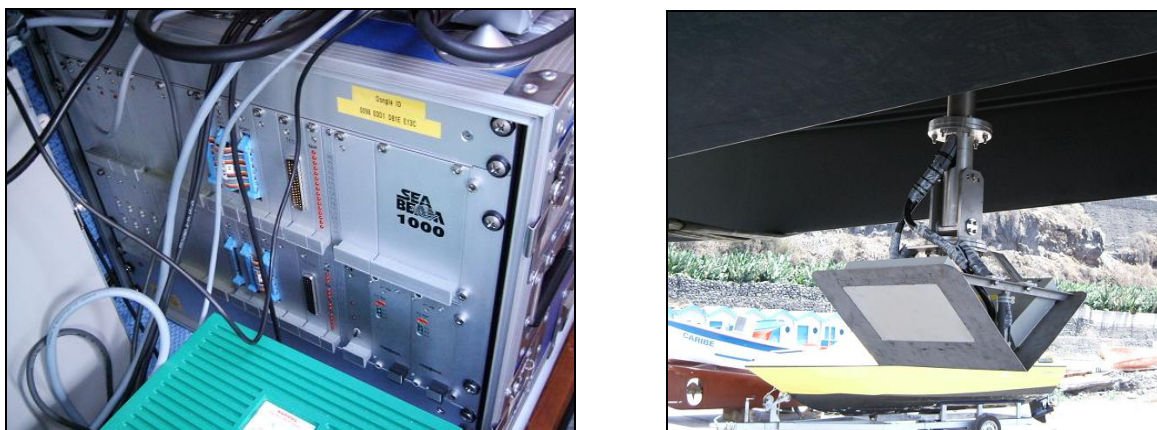
Figura 9 Unidad central de la Seabeam1000 (a la izquierda) y situación de los transductores en la embarcación utilizada (a la derecha).
