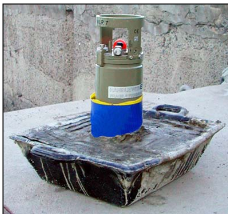
Figura 20 . Mareógrafo Aanderaa WLR-7 antes de ser fondeado en su posición definitiva. Obsérvese la base de cemento para su fijación en el fondo.
