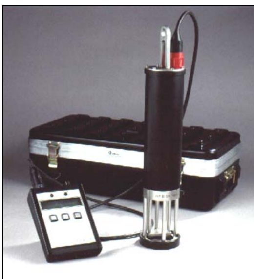
Figura 18 . Sonda SVP para la determinación de la velocidad de propagación del sonido en el agua
