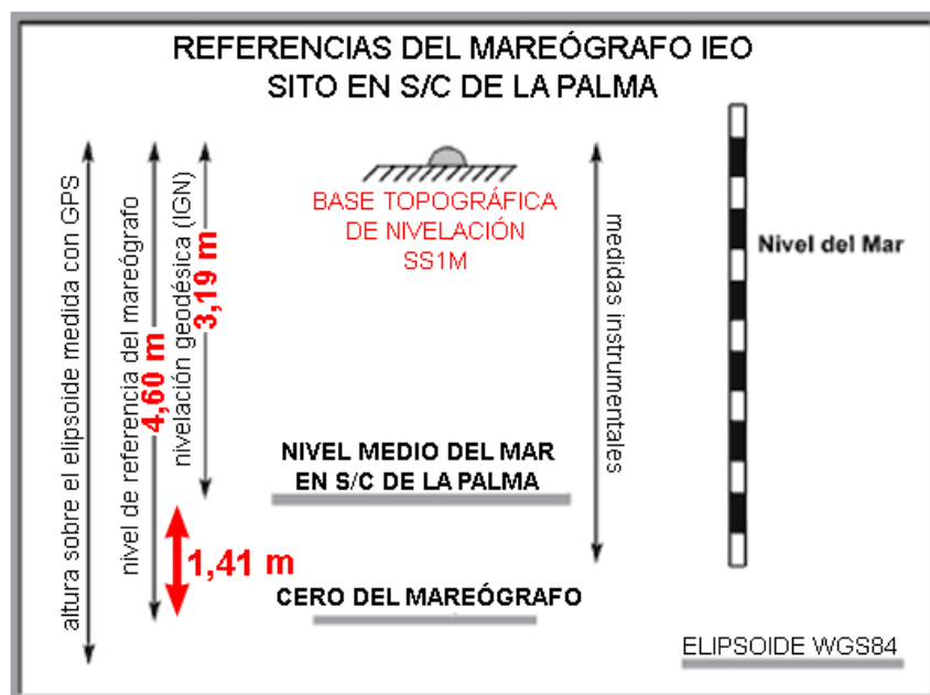
Figura 15.- Nivelación del mareógrafo IEO para la base SS1M
