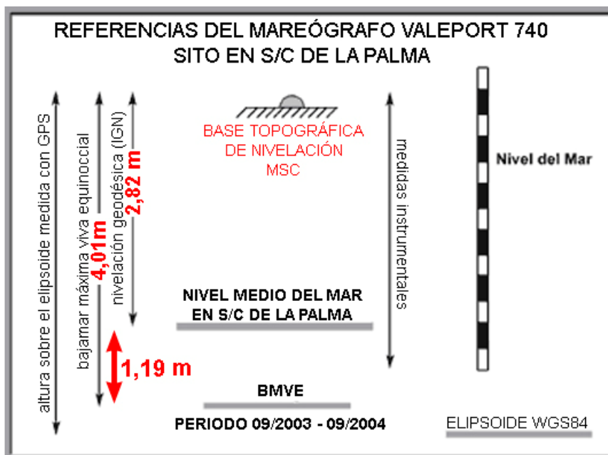
Figura 14.- Nivelación y bajamar máxima del mareógrafo Valeport 740
