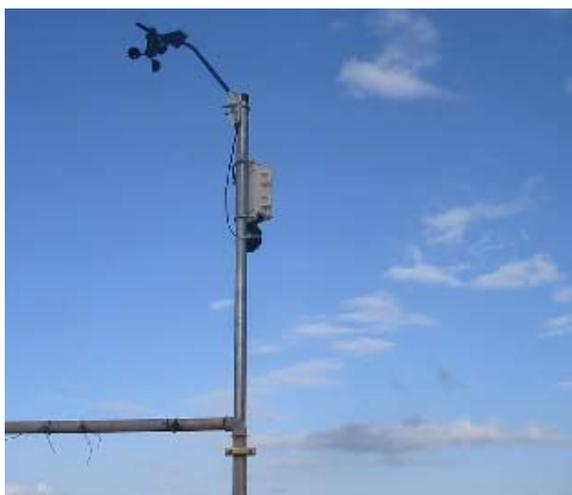
Figura 17 .- Aneómetro Davis instalado en San Andrés
