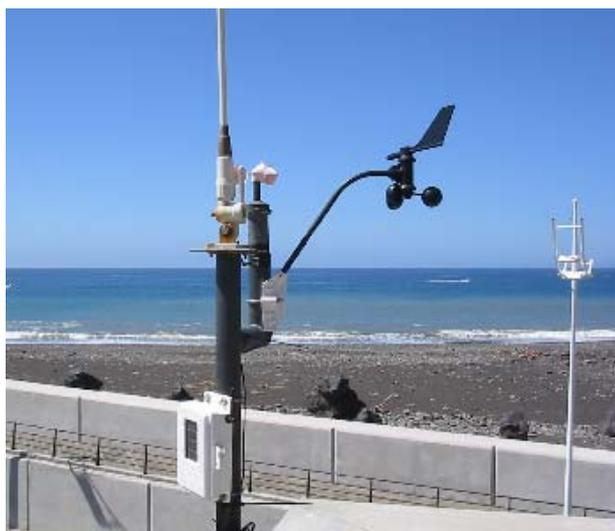
Figura 14 .- Aneómetro Davis instalado en la Capitanía del Puerto de Tzacorte
