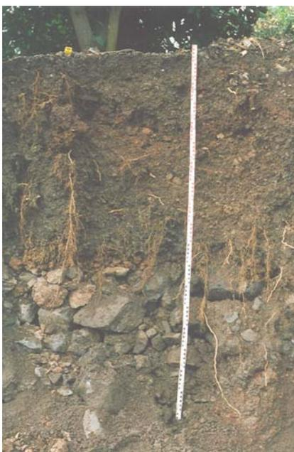
Figura 14 Corte de "sorriba" con suelo natural, donde se observa la capa de drenaje
