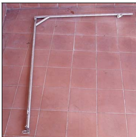
Figura 2 .- Pértiga usada para separar la sonda de la turbulencia creada por el barco
