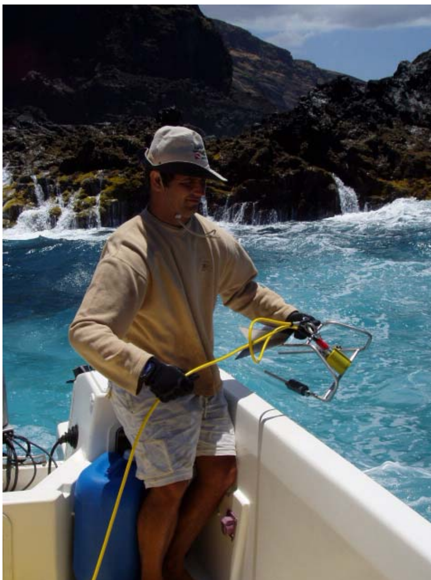
Foto nº 13 Realización de transectos con vídeo remolcado en La Palma mediante empleo de una embarcación DIPOL 600 CP, de 5,96 m de eslora
