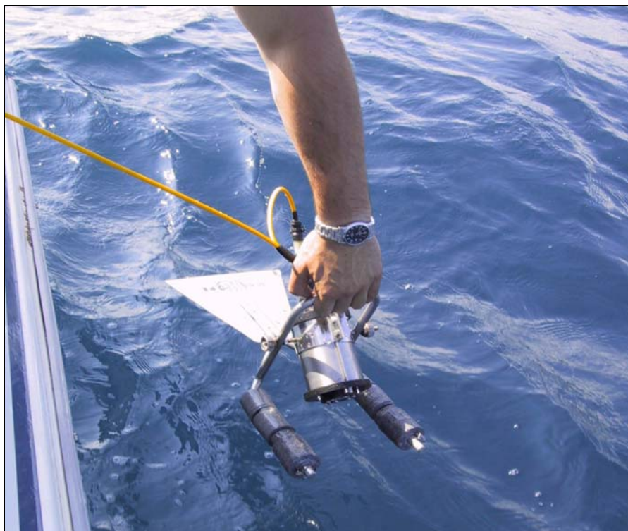
Foto nº 7 Trabajos con video remolcado
