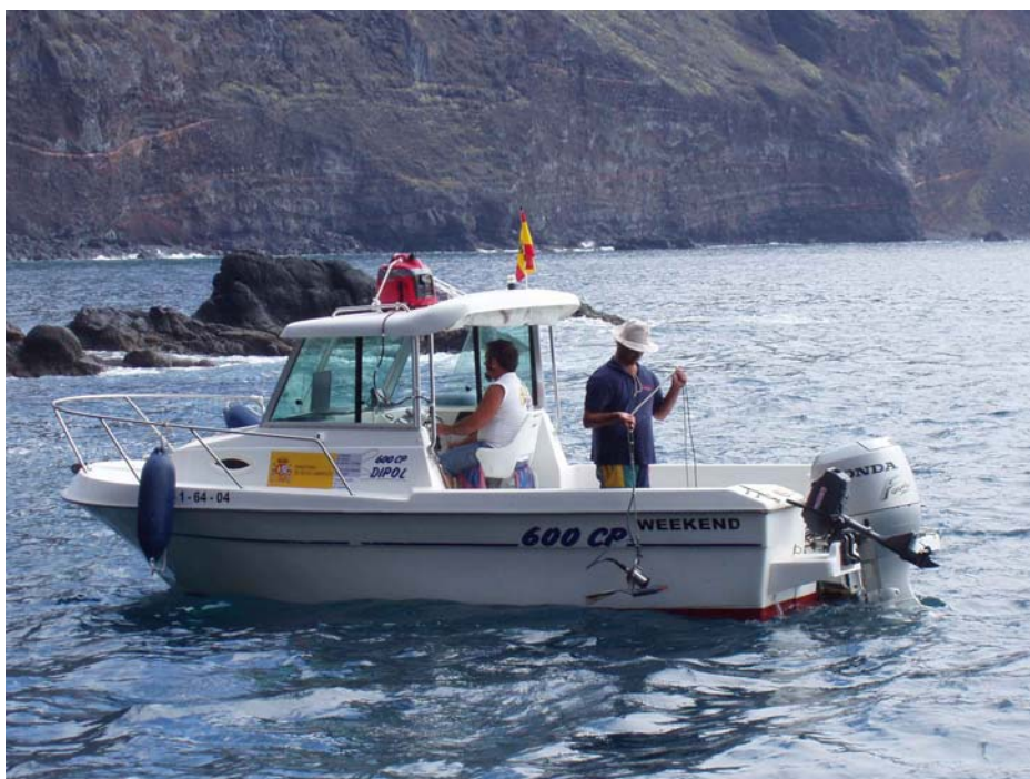
Foto nº 9 Realización de transectos con vídeo remolcado en La Palma mediante empleo de una embarcación DIPOL 600 CP, de 5,96 m de eslora
