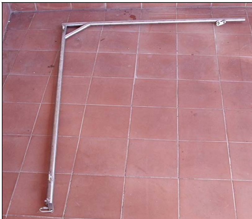
Foto nº 1 Pértiga usada para separar la sonda de la turbulencia creada por el barco
