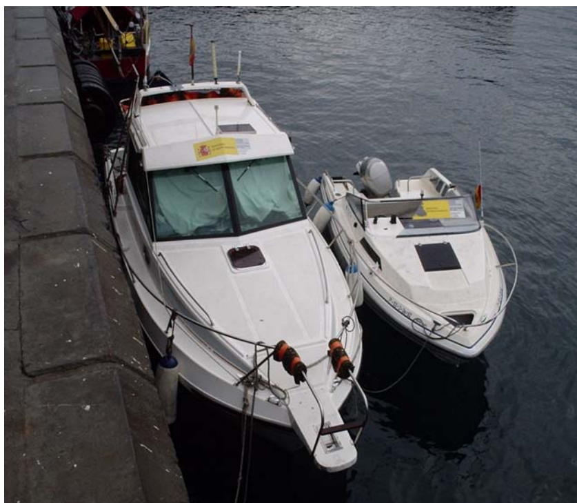
Foto nº 2 Embarcación de fibra y 6 metros de eslora usada para el mapeado en continuo
