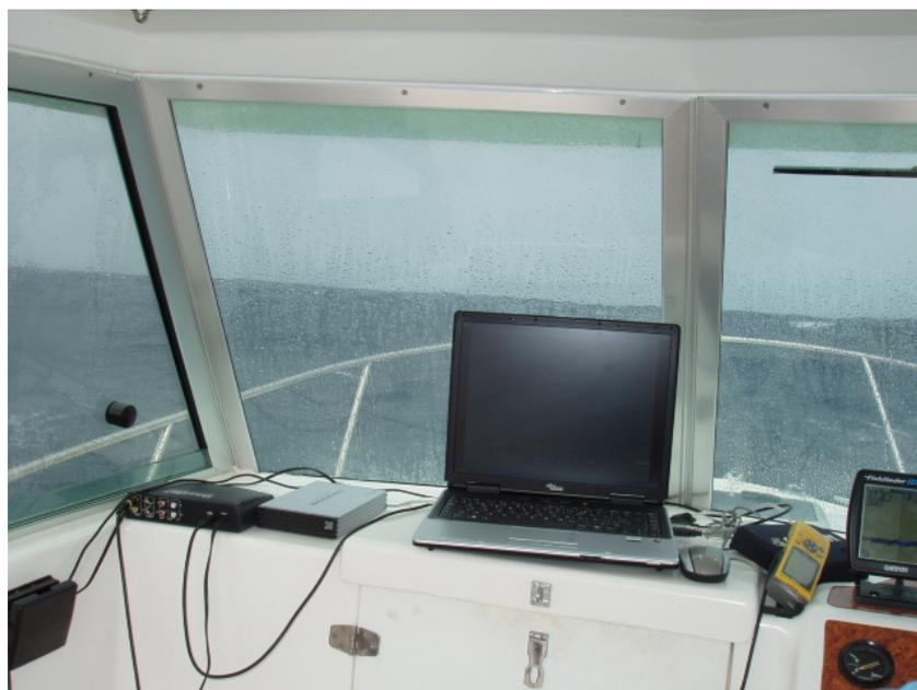
Figura 6 Montaje de Equipos en el interior de la embarcación DIPOL 600 durante la campaña de video remolcado
