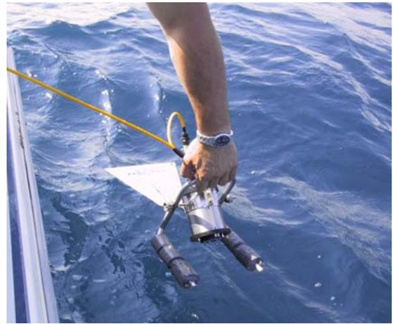
Figura 2 .- Equipos de video remolcado MARISCOPE, modelo MICRO utilizados en la campaña
