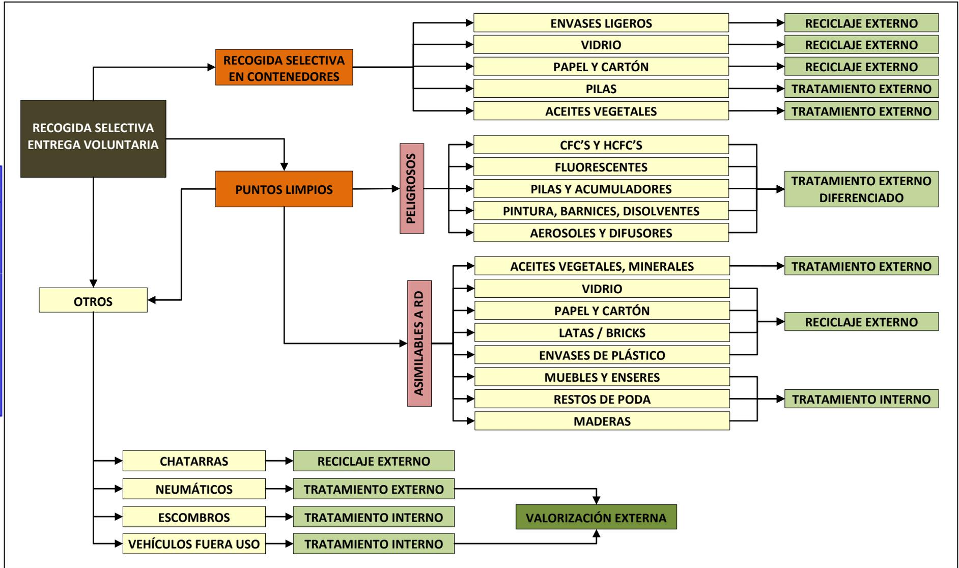
Figura 9: Diagrama de Recogida Selectiva de RD en La Palma
